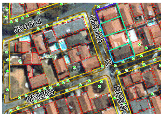
Figura 2 – Detalhe da figura anterior, com destaque em linhas verdes de desenho de lotes e em linhas azuis desenhos de testadas de lotes. Fonte: Adaptado de (Fonte: Foto aérea VistaAérea e Base geográfica do SIG da PBH – Prodabel).
