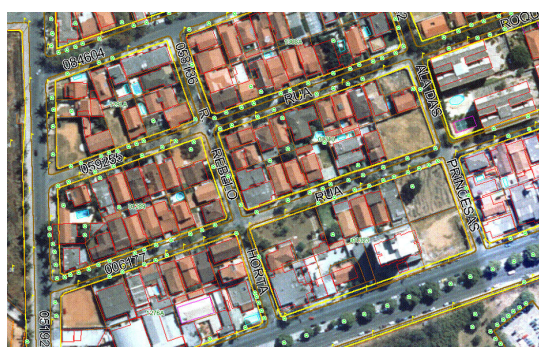
Figura 1 - Solução de montagem do SIG – Sistema de Informações Geográficas – contendo a vetorização de alguns elementos e o uso simultâneo da camada matricial (imagens) para visualização de outras informações. (Fonte: Foto aérea VistaAérea e Base geográfica do SIG da PBH – Prodabel)
