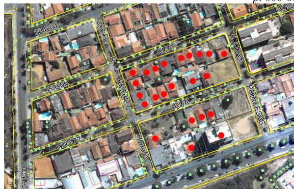
Figura 3 – Proposta de colocar a imagem apenas como um fundo de referência, sobrepondo a ela camada de símbolos ou pontos para identificação das unidades domiciliares, aos quais seriam associados os dados do banco de dados (tabelas do BCI – Boletim de cadastro Imobiliário).
