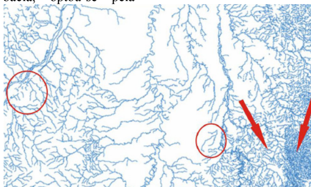
Fig. 1 - Mosaico da rede hidrográfica de cartas do IBGE. Destaque da descontinuidade de rios (círculos vermelhos) e na diferença metodológica entre duas cartas (indicada pelas setas vermelhas). Fonte: Projeto Geoxisto.
