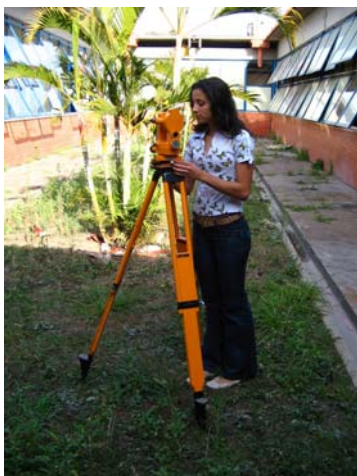
Figura 1: Teodolito montado na altura do observador
