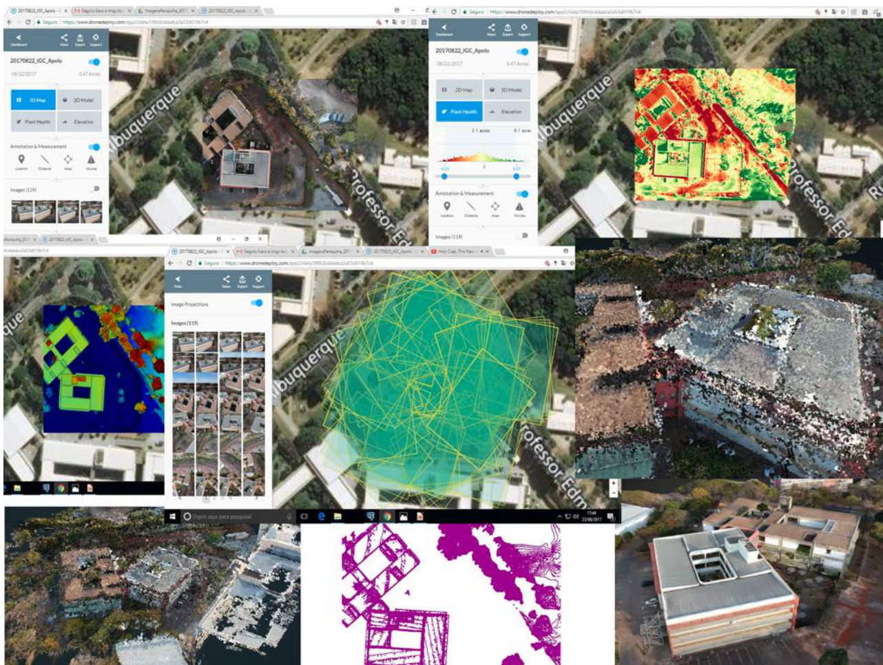
Figura 05 – Captura e tratamento de dados obtidos por VANT (Drone). Geração de Modelo Digital de Elevação a partir de nuvem de pontos e ortomagens. Exemplo de edificação no campus da UFMG (IGC).
