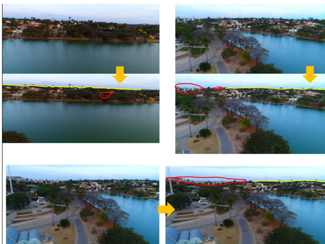
Captura de dados por VANT (veículo aéreo não tripulado) – Drone. Captura na Pampulha para estudos de campo de visada e impactos de volumes edificados e suas posições na paisagem.
