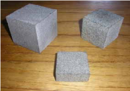
Figura 3- Provini di basalto Oberà – Probetas del basalto Oberà
