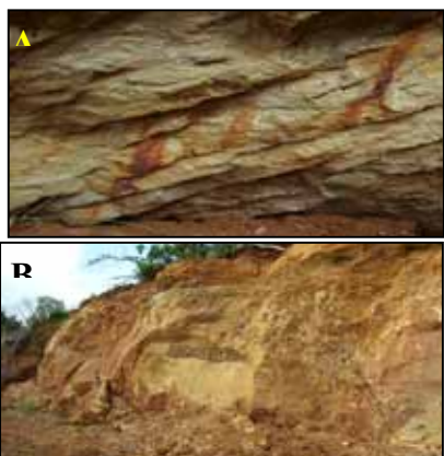
Figure 2. Gradone di calcare 1 della Formazione de La Tampa, mostra un letto non parallelo planare e noduli di ferro (A). Gradone 2 mostra un letto massivo (B) - Limestone stope face 1 of the La Tampa Formation, showing non-parallel planar bedding and iron nodules (A). Stope face 2 showing massive bedding (B).
