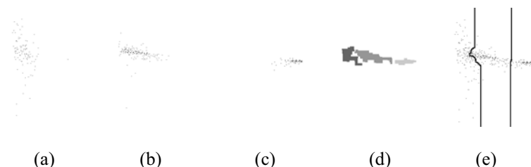
Figura 2 – Costruzione delle regioni di decisione nello spazio delle variabili intensità (ascisse)- tonalità (ordinate): (a) insieme di addestramento della classe biotite; (b) insieme di addestramento della classe quarzo; (c) insieme di addestramento della classe feldspato; (d) nuclei “forti” per le 3 classi; (e) frontiere di decisione sovrapposte ai punti iniziali - Construção das regiões de decisão no espaço das variáveis intensidade (abcissas)-tinta (ordenadas): (a) conjunto de treino da classe biotite; (b) conjunto de treino da classe quartzo; (c) conjunto de treino da classe feldspatos; (d) núcleos “fortes” para as 3 classes; (e) fronteiras de decisão sobrepostas aos pontos iniciais.
