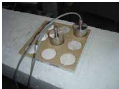
Figura 3- Misure del tempo di transito degli ultrasuoni – measurement of time transit of ultrasonic wave
