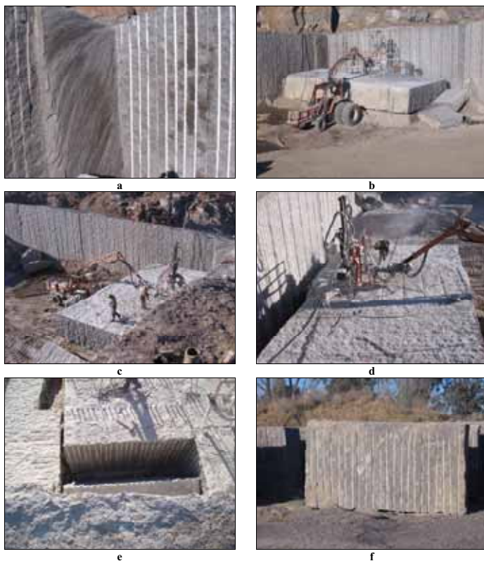
Figura 2 Principali step della produzione dei blocchi di granito nel cantiere Galasur S.A.: a) taglio dei blocchi, b) separazione e caduta, c-d-e) squadramento, f) blocco terminato.
