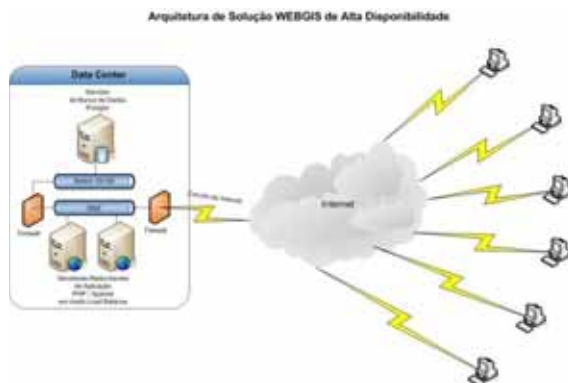
Figura 7 – Architettura dell'InfraStruttura per la soluzione WebGis As Alta Disponibilidade - Arquitetura de Infra-Estrutura para a solução WEBGIS de Alta disponibilidade.
