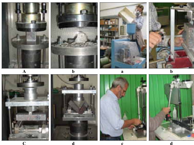
Figura 7. Esempio delle analisi fisico-meccaniche realizzate: a-b) Resistenza alla compressione e c-d) Resistenza alla flessione.
